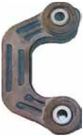
Eslabón final de suspensión rediseñado con ranuras para minimizar el uso del material mientras se mantiene una resistencia de funcionamiento segura.
