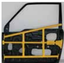
Panel lateral de Commuter Car. Diseño basado en un análisis de ingeniería reforzada, que proporciona la máxima resistencia por un peso mínimo.
